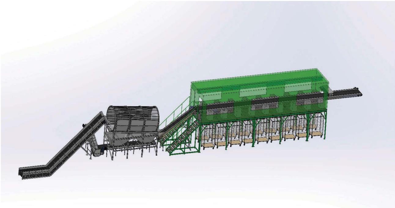
Рис. 1. Модель лінії щодо сортування твердих побутових відходів
