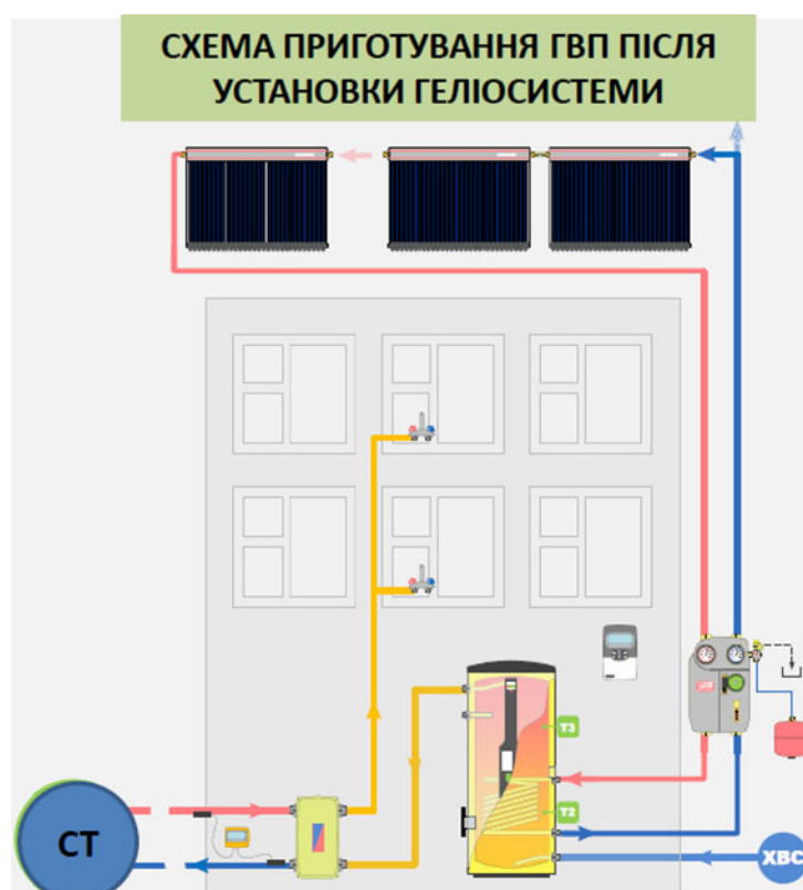
Рис.8.9 Принципова схема приготування ГВП після встановлення геліосистеми
