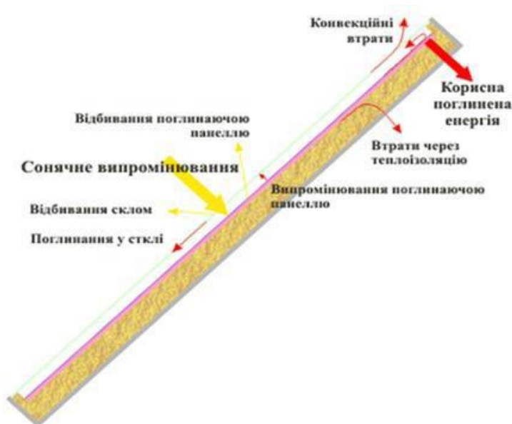
Рис. 6.2. Втрати теплової енергії у плоскому сонячному колекторі
