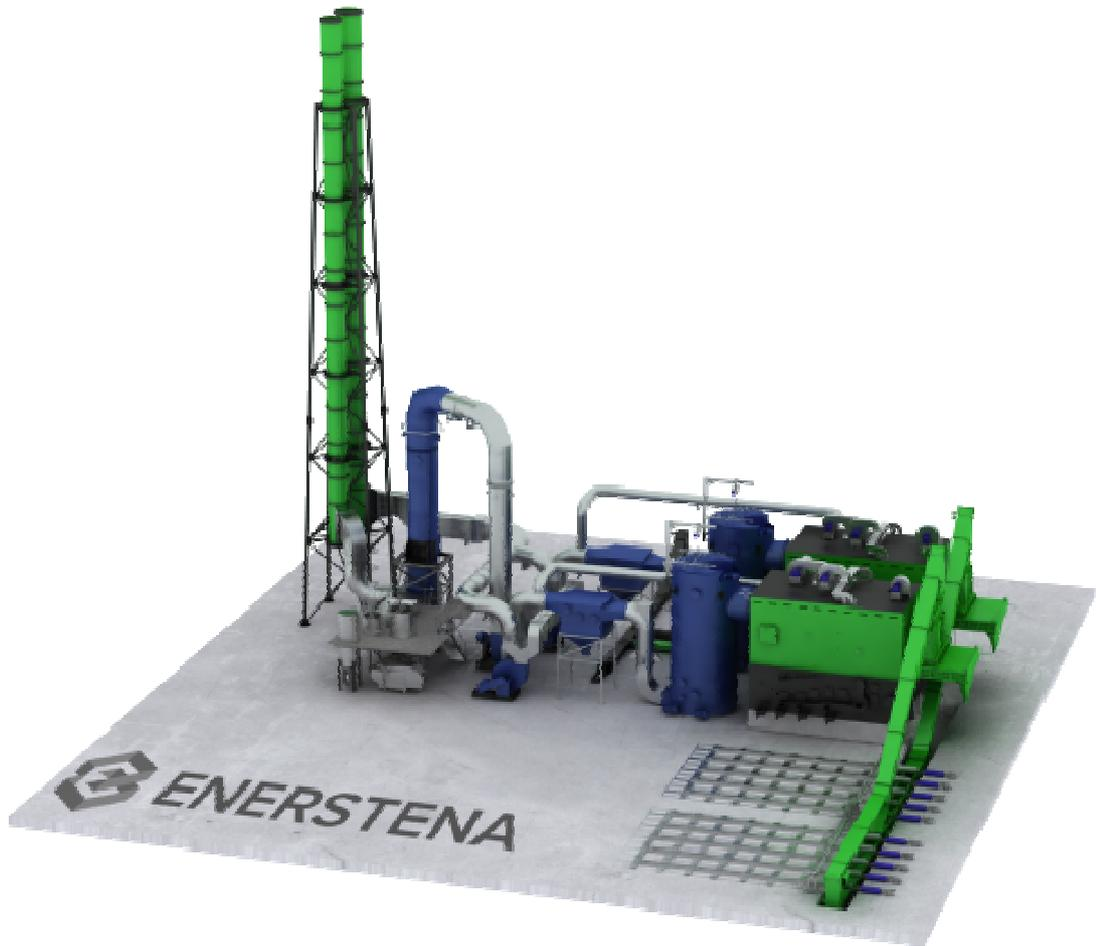
Рисунок 1.10 – Об’ємна модель обладнання котельні з двома котлами на біомасі
