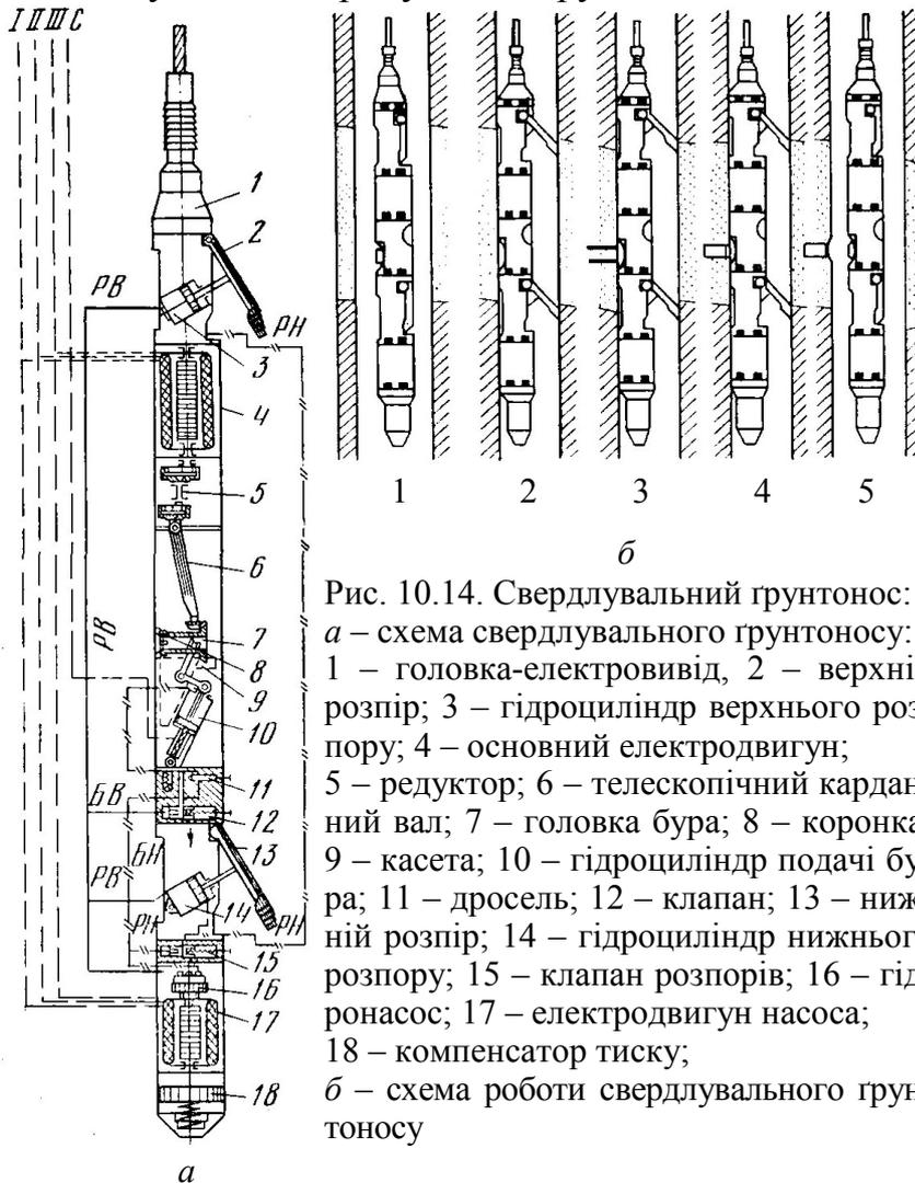
Рис. 10.14. Свердлувальний ґрунтонос:
