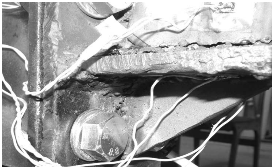
Рис. 2. Фрагмент балки в розтягнутій зоні прикріплення нижнього поясу і фланця
