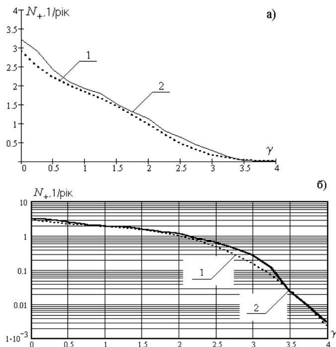
Рисунок – 5 Графіки річних викидів ВП снігового навантаження для метеостанції Семенівка в нормальній (а) та логарифмічній (б) шкалі: 1 – теоретичні; 2 – за чисельною моделлю
