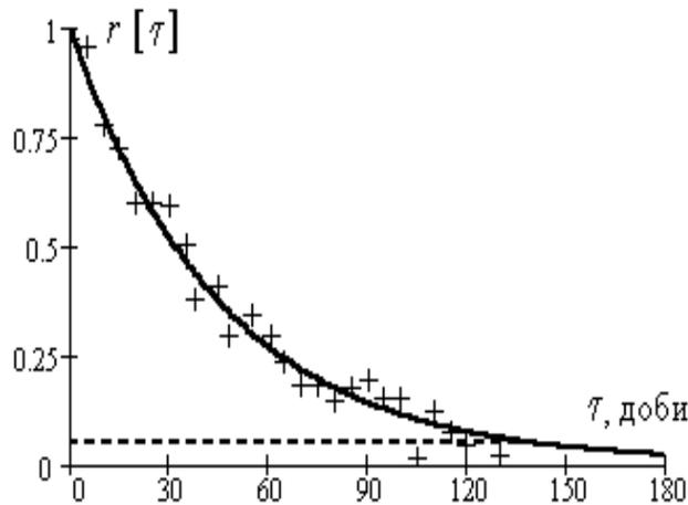
Рисунок 2 – Нормована кореляційна функція випадкового процесу снігового навантаження для метеостанції Семенівка
