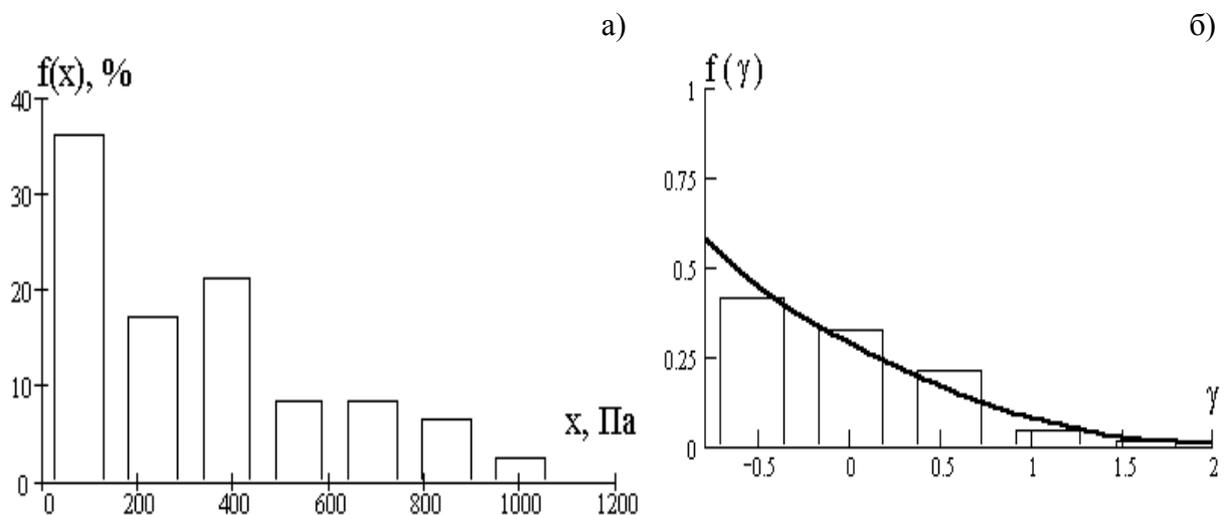
Рисунок 3 – Числові характеристики випадкового процесу снігового навантаження: а – гістограма снігового навантаження за всіма спостереженнями; б – розподіл ординат випадкового процесу снігового навантаження в нормованій формі для метеостанції Семенівка
