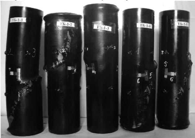
Рис. 2. Характер руйнування дослідних зразків серії ТБ із трубою 1
