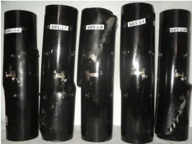
*Рис. 3. Характер руйнування дослідних зразків серії БВТ із трубою 1*
