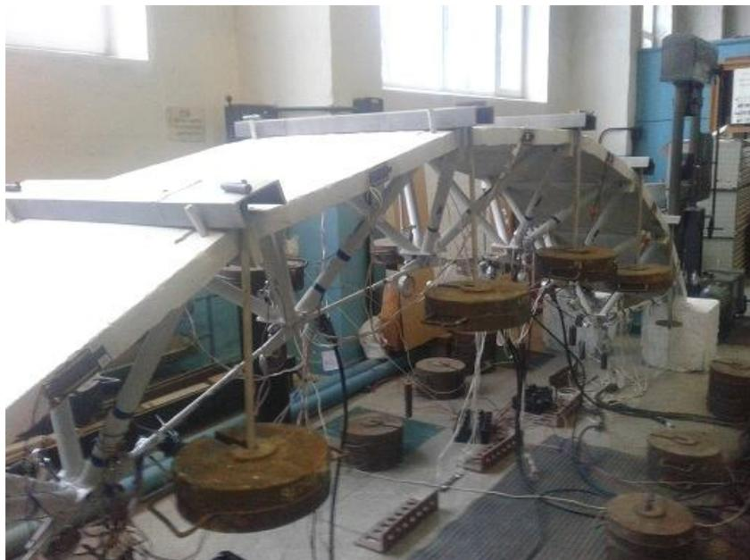
**Рис. 1. Загальний вигляд експериментального зразка просторової структурно-вантової сталезалізобетонної аркової конструкції**
