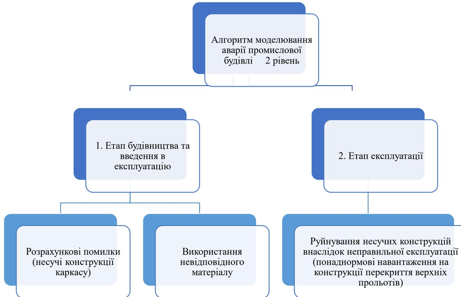
Рис. 5.18. Алгоритм моделювання 2 рівня значущості можливого виникнення аварій промислової будівлі
