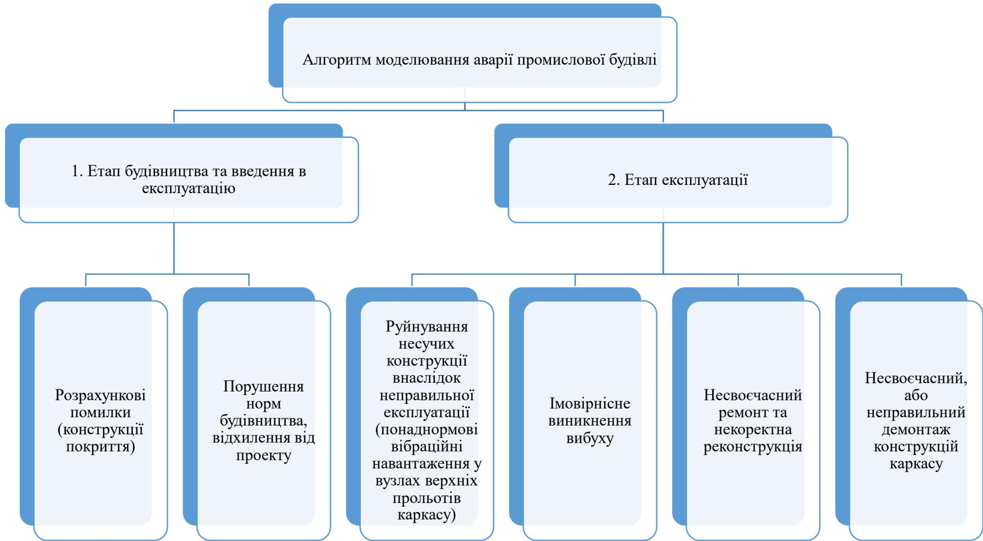
Рис. 5.7. Алгоритм моделювання 1 рівня значущості можливого виникнення аварій промислової будівлі
