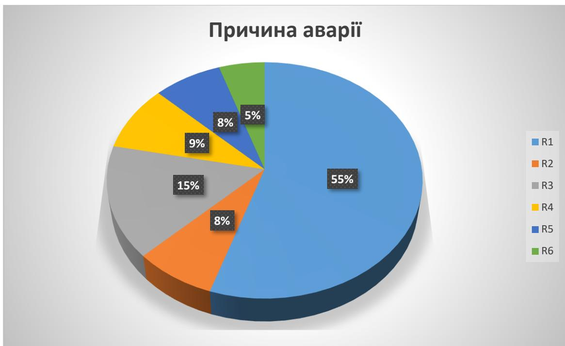
Рис. 3.15. Діаграма кількості аварій в залежності від причин на етапі будівництва
